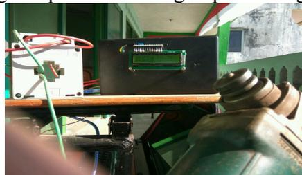
Gambar Foto Alat Saat Pengujian Sensor Arus
